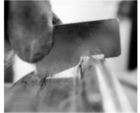
Kuva 1 Hyväksyttävä vannelaipan kulumisaste
