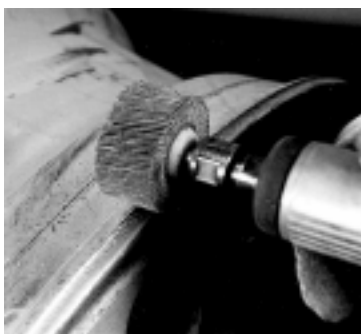
Kuva 5: Ilma- tai sähkötoiminen hiekkapaperilaikka.
