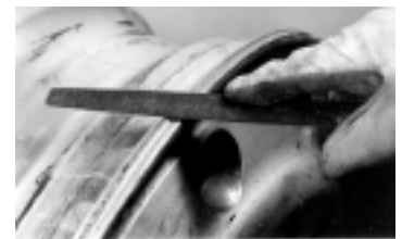
Kuva 4: Terävän reunan poisto käsin metalliviilaa käyttämällä.
