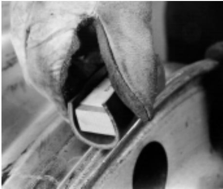
Kuva 2. Terävyysmitta valmistetaan kiinnittämällä puupalan ympärille renkaan sivusta leikattu tai vastaavanlainen pieni kumipala.
